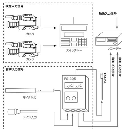
演劇や講演など2カメ、3カメ収録現場での音声収録時にレコーダーへの入力はライン固定の場合が多く音の歪みが発生しやすくなっています。FS-205/206はラインとマイクのどちらにも対応可能で、音声レベル差のある各講演者の声を平均的に収録し、拍手などの突発音による音の歪みを抑えることができます。
