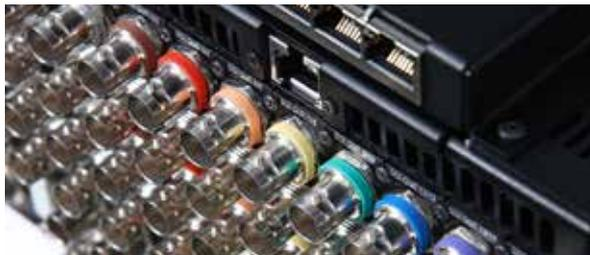
標準として、各系統の入力部、そして出力部の上のコネクタにリングをつけています。各リングの直下のコネクタがそのスルーアウトとして機能しています。入力部のスルーアウトはリクロック回路が内蔵されています。リングのカラーバリエーションは、黒、茶、赤、橙、黄、緑、青、紫、灰、白、透明があります。お客様にて色のご指定をいただくことも可能です。
