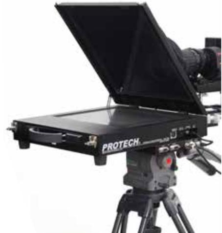
主な特長 ● 15 インチ プロンプター ● 輝度約 500cd/m、高コントラストディスプレイ ● バランサーを使うことなく多機種のカメラに対応 ● 高品位マルチコートミラーガラス採用 ● マルチ入力対応 ● フィールドでの取材に対応した DC12CV 駆動 (消費電力: 約 26W) ● プレイバックモニター機能 (SDI/RET 切替)
