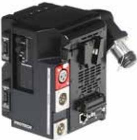
LS-900 は、筐体の大きさが NSR シリーズと同じですが、送信可能な SDI が何と、1 0 系統可能です。リターン回線ももちろんお使い頂けます。さらに、1 2 G-SDI にすべて対応しており、この小型サイズで 8K 伝送が複数 Ch 行える点が、他にはない大きな特徴です。LAN やインカムなどの機能も搭載、さらにインカム部分にはオーディオアンプまで搭載しているため、PROTECH 小型光伝送装置の中でも一番のハイエンドモデルといえます。
