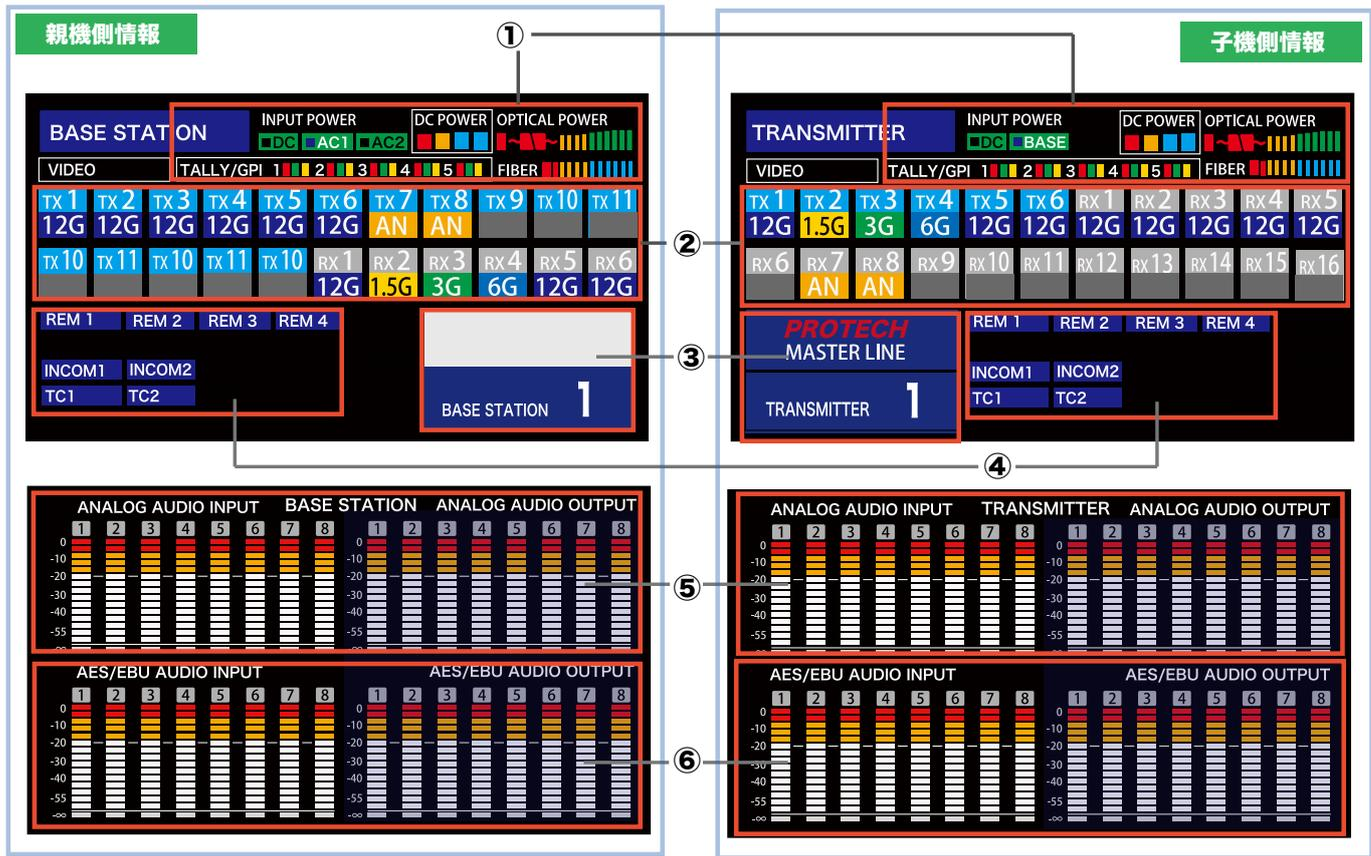
①インジケータなどを表示します。『INPUT POWER』は、どの電源で本体が動いているかを表示します。『DC POWER』は、MASTERLINE からその他の機器に給電した時、どれだけの余裕があるかを表示します。『OPTICAL POWER』は、光強度を表示し、光ケーブルやコネクタなどの状態を確認します。下段の『FIBER』と表示されているものは、光強度の最低ラインを表示しています。『TALLY/GPI』は、R タリー、G タリー、GPI の信号を表示し、何番が機能しているかをわかりやすくしています。
