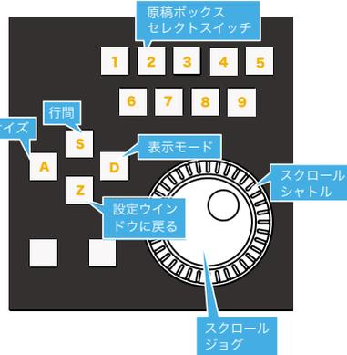
専用コントローラー HPC-CNT1 Controller
