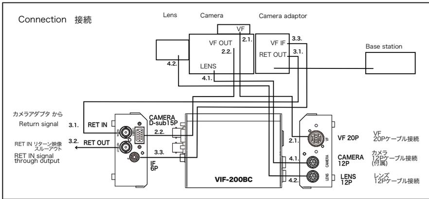
VIF-200BC は、ソニー社の VF に光ベースステーションから入力されたリターン信号、タリー信号を表示するアダプターです。接続も簡単で、電源も光カメラアダプターから供給されるため、スマートに設営が可能です。
