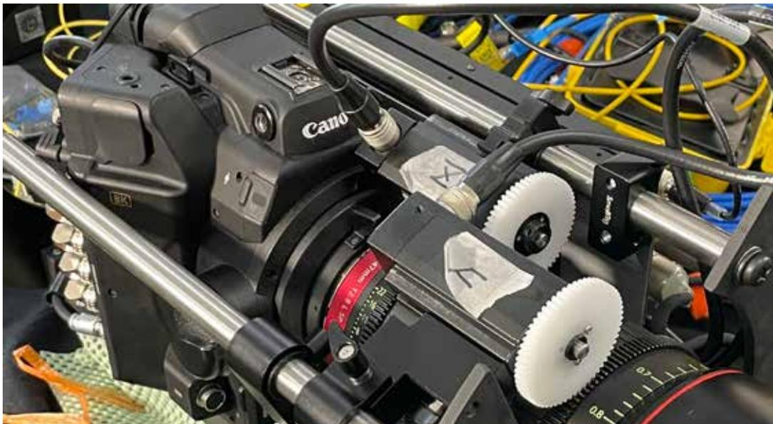
BM-W30F の装置、また、8K 対応のバックラッシュがほぼ 0 のモーターを、水中撮影の中で使っていただきました。ズーム、アイリス、フォーカスのそれぞれをロッドで固定し、高精細な操作が可能な用に特注製作をいたしました。このシステムは光伝送装置を用いての運用で、特注リモートシステムとして運用しております。ハウジングの中にコンパクトにカメラ、ギアモーター、そして光伝送装置を詰め込んだシステムです。
