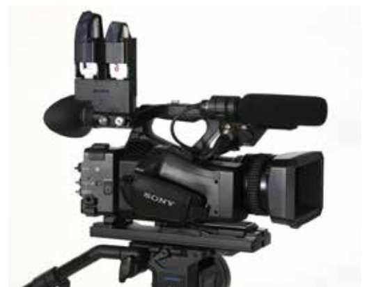
カメラ装着時の写真。構成はソニー社製カメラ PXW-Z280/ソニー社製 USB 取付アダプター CBK-DL1 と USB 端末、WIB-Z280 を組み合わせた写真です。
