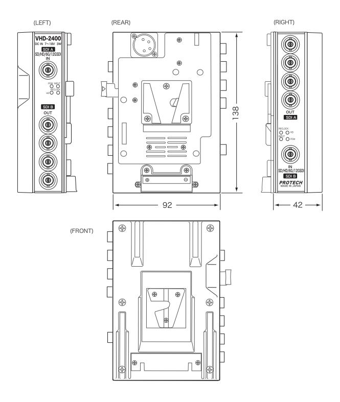
外形寸法図 (単位:ミリ) Dimensions (unit: mm)
