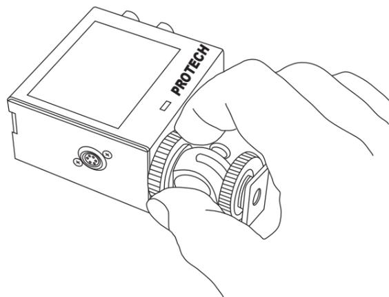
A2. アクセサリーシュータイプのカメラに取り付ける場合は止まる位置までスライドさせます。シューから抜けないようにシュー固定ネジにて固定します。角度調整固定ネジをゆるめてモニターの見やすい位置が決まった後再度固定ネジをゆるめます。
