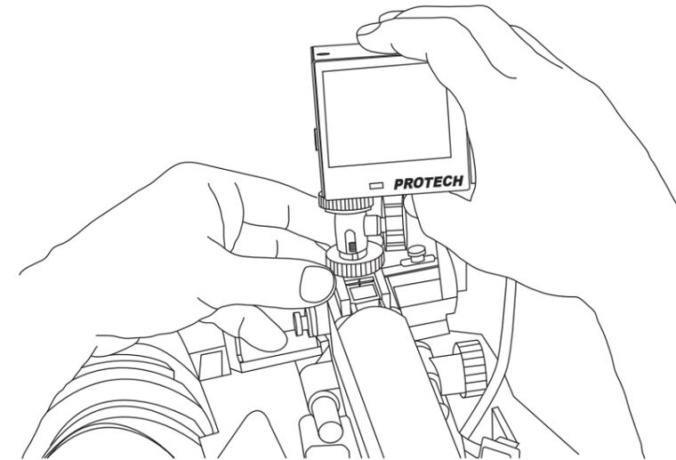
B2. 1/4インチネジ穴タイプのカメラに取り付ける場合はユニバーサルヘッドの下部の1/4インチネジ穴に1/4オスネジアダプタを取り付けた後、角度調整固定ネジをゆるめて下部のネジをカメラのネジ穴に合わせてねじ込みます。モニターの見やすい位置を決め角度調整固定ネジにてゆるめて固定します。
