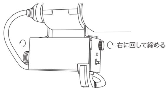
4.12Pケーブルをカメラのレンズ接続用12Pコネクタに接続します。
