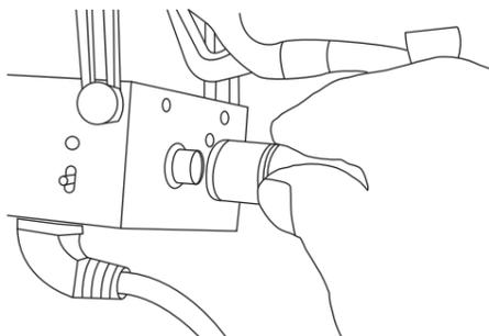
3.カメラアダプタと接続するケーブルVC-450を接続した後VIF-100を上押し上げて左右のネジにて固定します。
