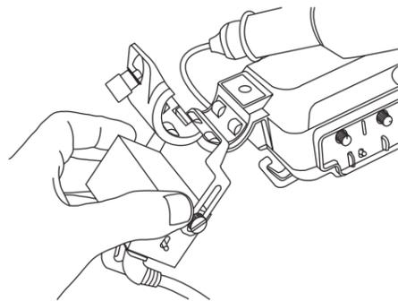
2.ビューファースとカメラを接続しているケーブルをはずし、VIF-100に接続し、VIFのケーブルをカメラに接続します。
